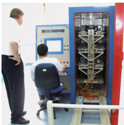
Bild 7: Temperaturkompensation von Prozesstransmittern bei Wecan Precision Instruments. In jeden Klimaschrank passen 64 Transmitter. Derzeit sind 5 baugleiche Schränke in Betrieb.
