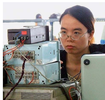
Bild 9: Abgleicharbeiten an Transmittern in der Fertigung von Chongqing Yutong Instruments Co., Ltd.
