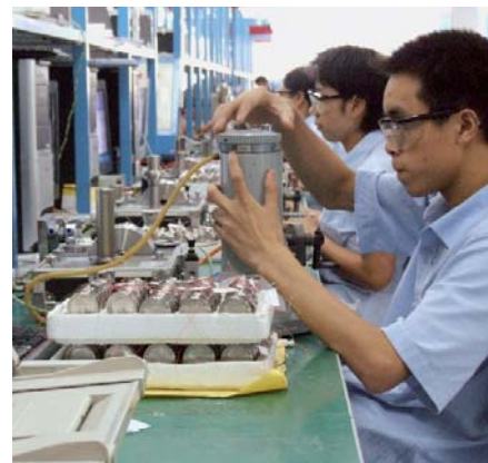
Bild 6: Kalibrierung von Drucktransmittern für die Prozesstechnik bei Wecan Precision Instruments
